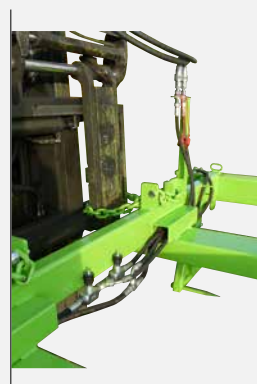
Montage hydraulique avec réglage pour bras télescopiques
