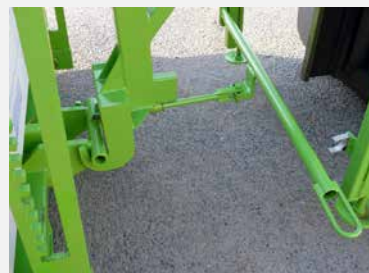
5 Préhension du chariot MP par le palonnier - Levier décliné pour verrouillage automatique du crochet sur le chariot MP sans intervention du cariste
