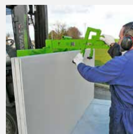
9 Chargement facilité par simple glissement des plaques vers la droite - Après distribution, bras de réglage à repositionner pour maintien des plaques restantes
