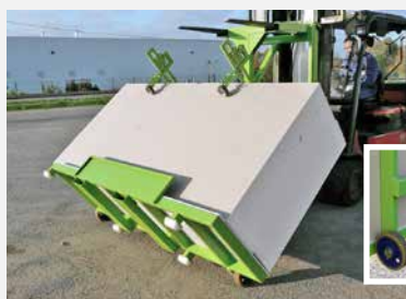
6 Basculement du chariot à la verticale, 4 patins PEHD évitant marquage au sol
